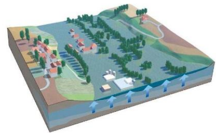
inondation de nappe
