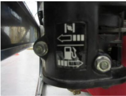
↪ Si le moteur est froid, tirer le levier de starter à fond,
