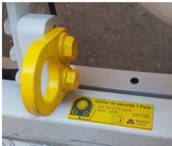
Possibilité de réaliser l'amarrage du dispositif antichute "Mansafe" directement sur ces points de fixations identifiés.
