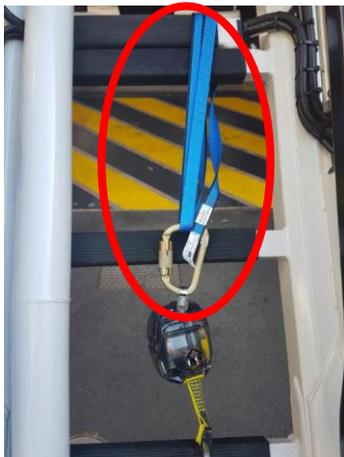
Utilisation des anneaux cousus (bleus ou rouges) pour amarrer le dispositif antichute à rappel automatique "Mansafe" sur un échelon.
