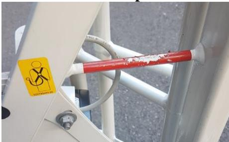
Ces deux points de fixation (modèles suivant type MEA) permettent uniquement le maintien pour le travail.
