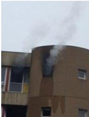
Des fumées ayant une vitesse laminaire, sortant lentement, indiquent que le foyer ne se trouve pas à proximité de l'ouverture. Les fumées chaudes provenant du foyer, poussent les fumées refroidies (accumulées en partie haute) vers les ouvertures. Les fumées s'élèvent à la sortie de l'ouverture directement le long de la façade.
