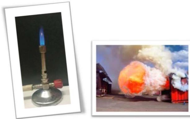
Il est à noter que la différence entre les deux flammes ne peut pas être tranchée aussi facilement. Le système feu étant dynamique, nous pouvons passer d'une flamme de pré-mélange à une flamme de diffusion ou inversement.
