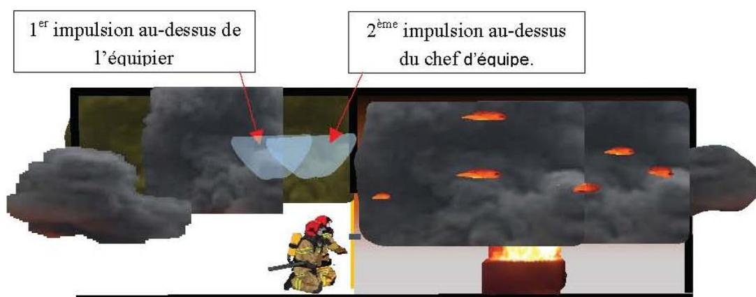
Mise en suspension de gouttelettes d'eau limitant le risque d'inflammation
