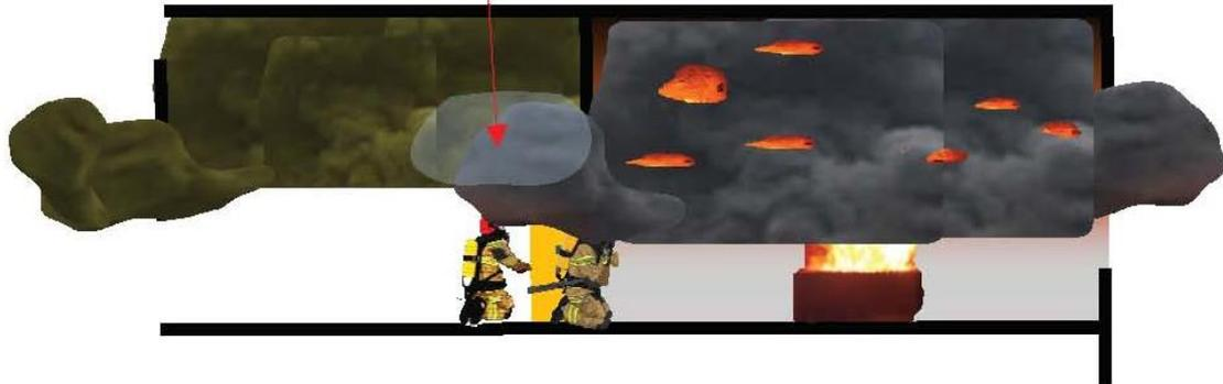
→ Ils doivent contrôler **la solidité du plancher** et **évoluer**, dans la mesure du possible, **le long des murs**.
