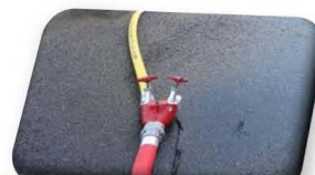
L'équipier raccorde la première lance à gauche dans le sens de l'eau
