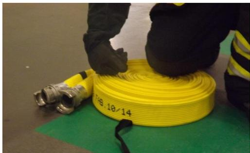
Une fois le tuyau roulé en escargot, on viendra mettre son genou dessus afin de mettre le plus à plat possible le tuyau.
