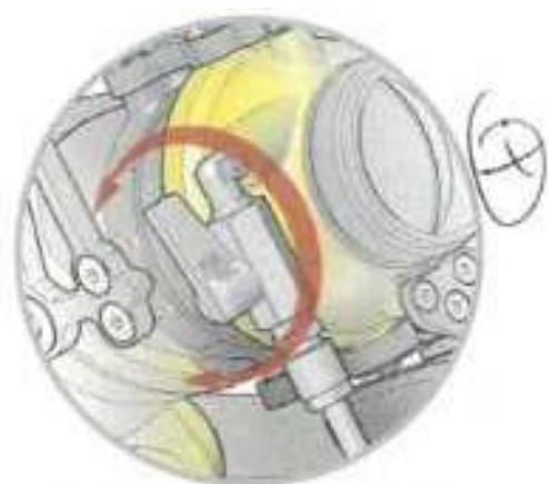
Robinet de marche/arrêt et réglage de la vitesse d'oscillation
