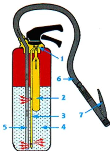
Lorsque l'utilisateur actionnera la gâchette (7), le gaz carbonique poussera l'agent extincteur, via le tube plongeur, vers le tuyau puis soit la buse soit le pulvérisateur (figure de droite).
