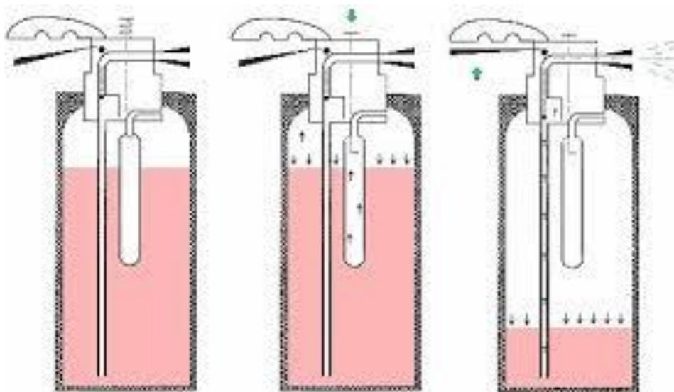
Avant utilisation, aucune pression ne règne dans l'appareil (figure de gauche).
