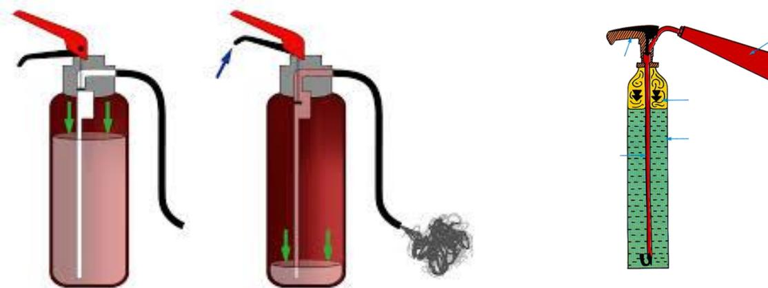
Rappel dans le cas des extincteurs à CO<sub>2</sub>, c'est le gaz carbonique qui est comprimé
