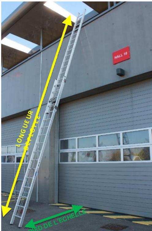
L'échelle ne doit être ni trop redressée ni trop inclinée ; dans le 1<sup>er</sup> cas, elle risquerait de basculer, dans le second de glisser, dans les deux cas la montée et la descente seraient peu commodes.
