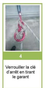
Tirer fermement afin de bloquer la boucle contre le brin supportant la charge.
