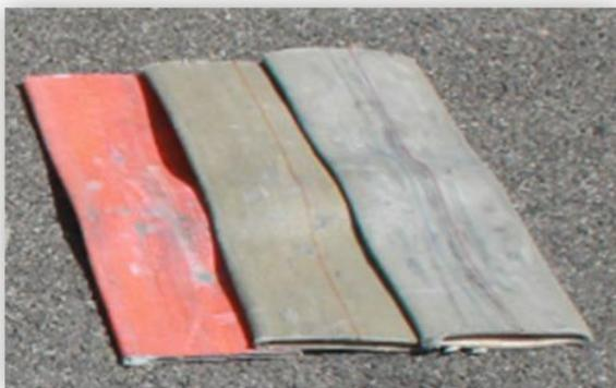
Pour éviter que la corde ne frotte sur des angles vifs ou sur des matériaux coupants qui l'endommageraient, on utilise des protections.
