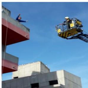
Echelle aérienne disposant d'une plate-forme de sauvetage.
