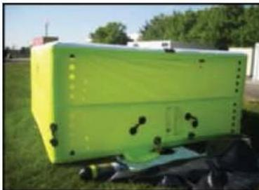
Le LCPS gonflé en dehors de la zone de saut potentiel, il peut être déplacé facilement par deux SP uniquement en utilisant les poignées de transport noires.
