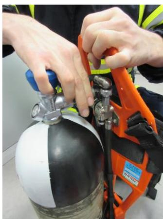
Prendre une bouteille pleine et enlever l'opercule protégeant le filetage des impuretés.
