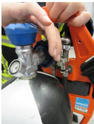
Dévisser le détenteur HP/MP à la main = ne pas utiliser d'outils même en cas de résistance.
