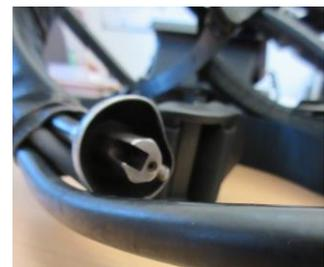
**Modèle QS :** Armement du système sonore de détresse et du sifflet de fin de charge : se fait automatiquement car la mise en pression du système déclenche la mise en route du SPIROGUIDE.
