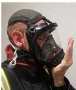
Contrôler l'étanchéité à l'inspiration et à l'expiration en appliquant **sans appuyer**, la paume de la main sur l'emplacement du micro-régulateur (SAD).
