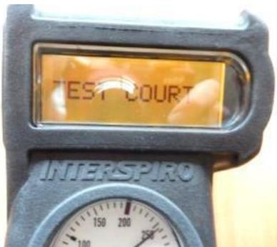
**Modèle QS** : Robinet avec déclenchement du test court à valider en appuyant sur le bouton noir.
