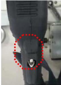
Sur le modèle QS le sifflet se situe derrière le SPIROGUIDE.
