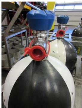
Les bouteilles pleines sont généralement munies d'un bouchon qui permet d'une part de les différencier des bouteilles vides et d'autre part il empêche les impuretés de pénétrer dans le goulot.
