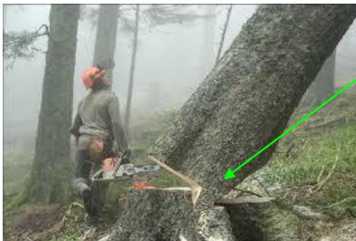
Cette bande agit comme une charnière contrôlant la chute de l'arbre et empêchant le tronc de glisser, pivoter ou rebondir
