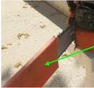
Lorsque la machine est remise ou non utilisée, il faut remettre le **Protège-guide**.
